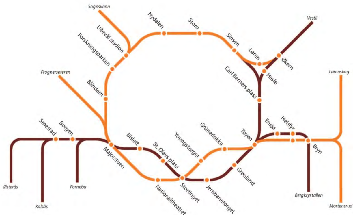
Figur 10 Anbefalt prinsipp for metrosystemet. Ny metrotunnel fra Majorstuen til Bryn knyttes sammen med dagens tunnel på Stortinget.
