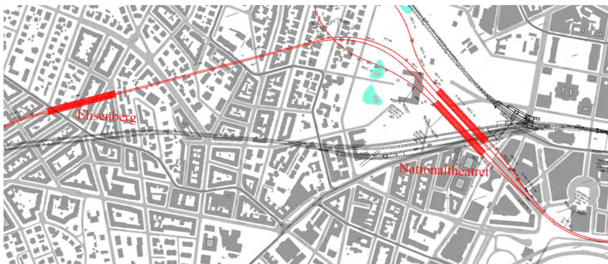
Figur 8-8 Ny S-banetrasé med to nye toghaller ved Nationaltheatret. Alternativ linje via Rådhusplassen.
